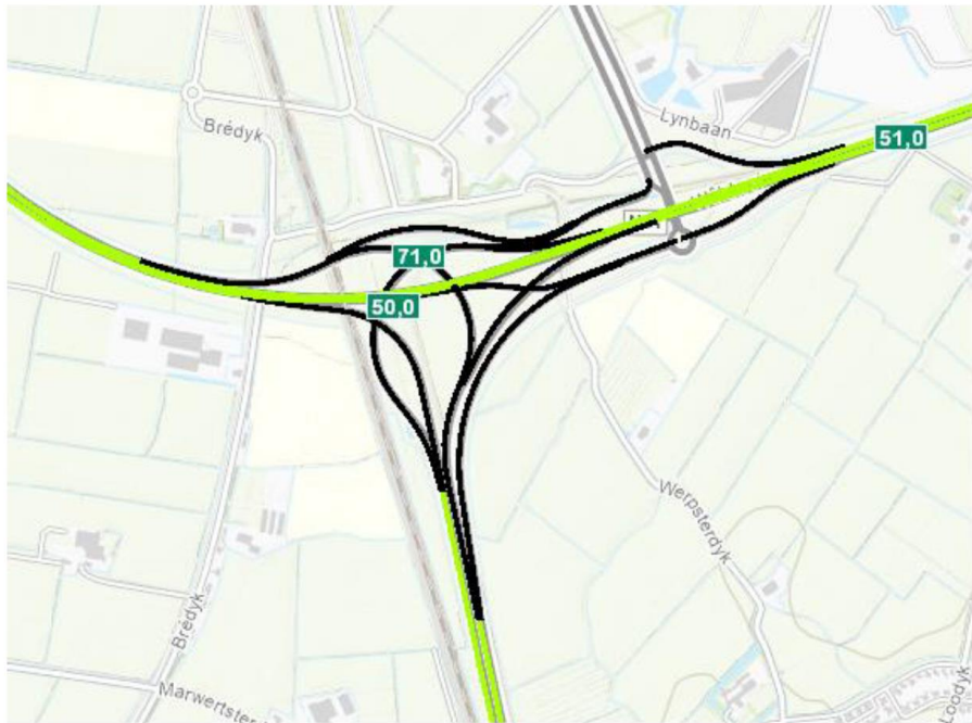
Figuur 6 Aanwezige wegverharding in knooppunt Werpsterhoek: zwart = DAB, groen = 1LZOAB. In het register is dezelfde wegverharding opgenomen.
